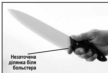
Малюнок 5. Якщо лезо вашого ножа має значну незаточену ділянку біля руків'я, може бути зручно помістити палець за нею під час заточування.
