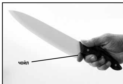
Рисунок 5. Если у ножа значительный чойл, во время заточки возможно будет удобно поместить указательный палец в чойл или сразу позади него
