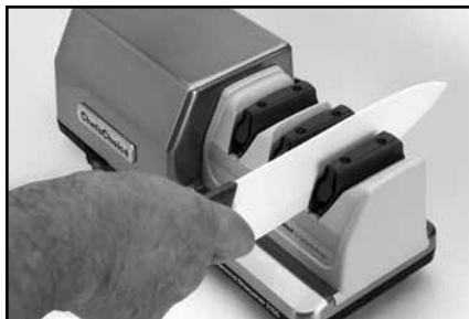
Рисунок 3. Финишная полировка керамического ножа в Устройстве 3.
