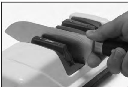
Рис. 17. Поместите указательный палец, как показано, позади незаточенной части, когда нож вставляется в паз точилки. (см. совет 8.)
